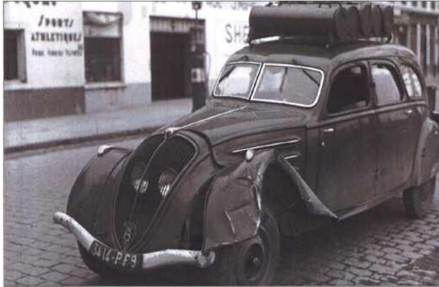
Le principe du gazogène est simple : il s'agit d'employer un combustible solide contenant du carbone – notamment du bois ou du charbon de bois – pour la production d'un « gaz pauvre » qui permet d'actionner un moteur. Photo DR-Collections bibliothèque municipale de Lyon
